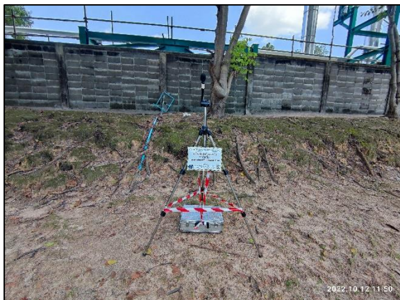
รูปที่ 3.21 การตรวจวัดระดับเสี่ยงโดยทั่วไป บริเวณ ริมรั้วด้านทิศเหนือของที่ตั้งโครงการ (N2)
