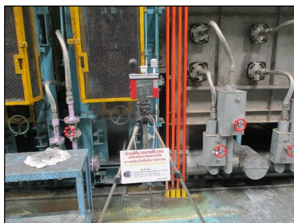
รูปที่ 3.55 การตรวจวัดระดับความร้อนในพื้นที่ทำงาน บริเวณ Annealing Process : MCL 3
