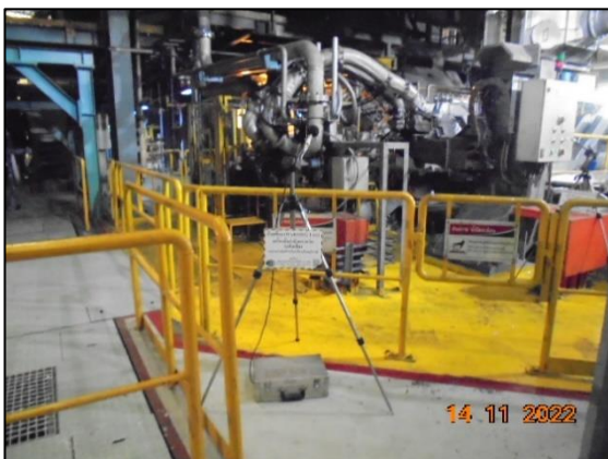
รูปที่ 3.44 การตรวจวัดระดับเสียงในพื้นที่ทำงาน ( L_{eq} 8 hr.) บริเวณ Zincalume Pot Area (MCL 2)
