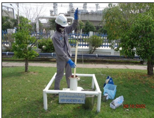
รูปที่ 3.26 การเก็บตัวอย่างคุณภาพน้ำใต้ดิน บริเวณ Gw 2
