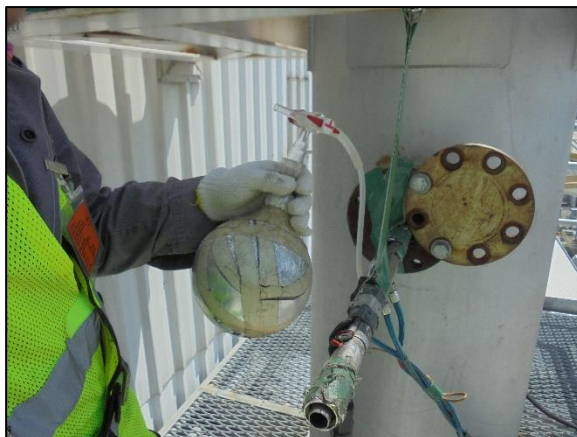
รูปที่ 3.14 การเก็บตัวอย่างคุณภาพอากาศในปล่องระบาย บริเวณ Passivation Stack MCL2 (S10)
