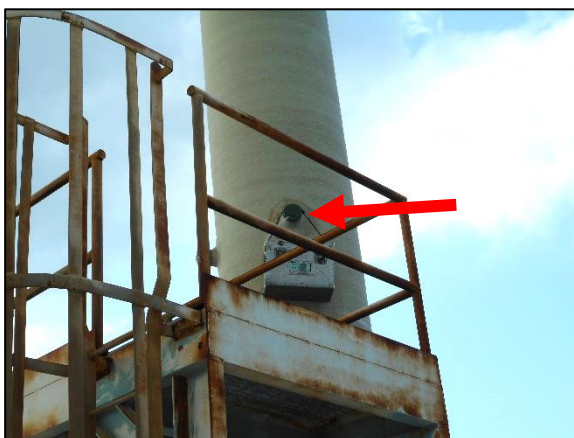
รูปที่ 3.6 การเก็บตัวอย่างคุณภาพอากาศในปล่องระบาย บริเวณ Pickle Line Fume Stack PKL (S1)
