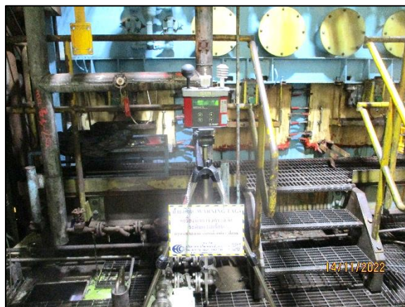
รูปที่ 3.50 การตรวจวัดระดับความร้อนในพื้นที่ทำงาน บริเวณ Annealing Process : MCL 1
