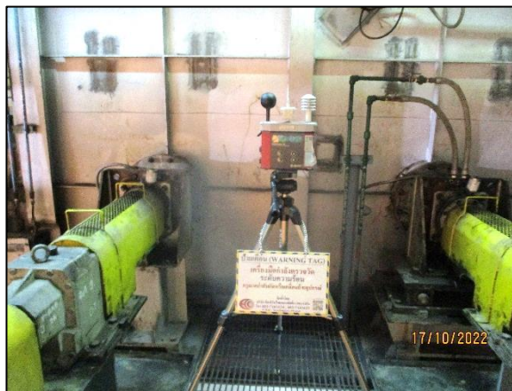
รูปที่ 3.49 การตรวจวัดระดับความร้อนในพื้นที่ทำงาน บริเวณ Zincalume Line Cleaning : MCL 2
