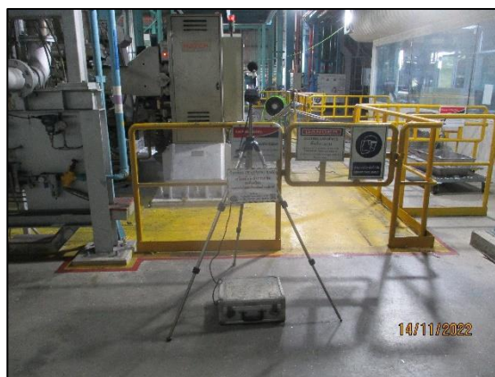
รูปที่ 3.46 การตรวจวัดระดับเสียงในพื้นที่ทำงาน ( L_{eq} 8 hr.) บริเวณ Zincalume Pot Area (MCL 3)
