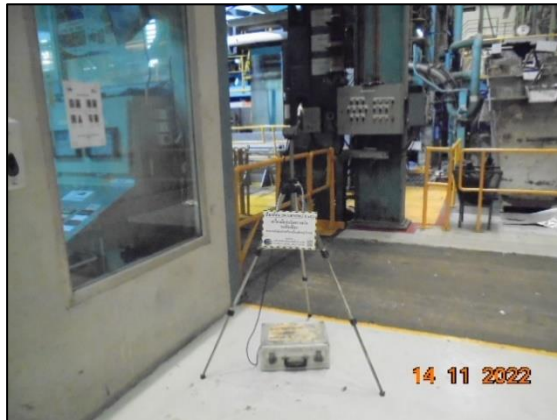
รูปที่ 3.43 การตรวจวัดระดับเสียงในพื้นที่ทำงาน ( L_{eq} 8 hr.) บริเวณ Zincalume Pot Area (MCL 1)
