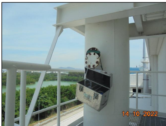
รูปที่ 3.18 การเก็บตัวอย่างคุณภาพอากาศในปล่องระบาย บริเวณ Cleaning Fume Exhaust Scrubber Stack MCL 3 (S15)
