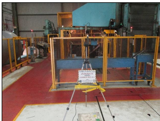
รูปที่ 3.45 การตรวจวัดระดับเสียงในพื้นที่ทำงาน ( L_{eq} 8 hr.) บริเวณ Cold Reduction Mill (In front of Mill CRM)
