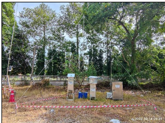
รูปที่ 3.19 การเก็บตัวอย่างคุณภาพอากาศในบรรยากาศ บริเวณ วัดมาบชูด
