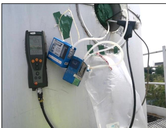
รูปที่ 3.4 การเก็บตัวอย่างคุณภาพอากาศในปล่องระบาย บริเวณ RTO Stack CPL (S13)
