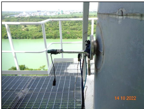
รูปที่ 3.17 การเก็บตัวอย่างคุณภาพอากาศในปล่องระบาย บริเวณ Painting stack MCL 3 (RTO) (S18)
